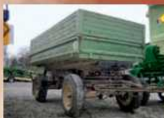
Anhängerk HK5 , Bj. 1963, 25 km/h, Betriebserlaubnis, Nutzlast 4750 kg
