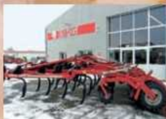
Horsch Tiger 4AS , Bj. 2005, Reifenpacker AS ausgeschäumt, Zwischenringpacker, klappbar
