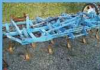
Lemken Smaragd 9/500 , Bj. 2000, Grubber mit Federsteinsicherung
