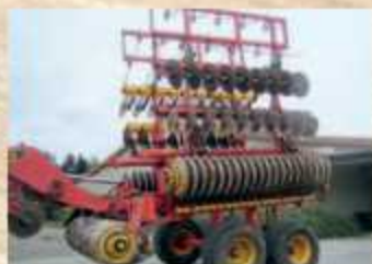
Väderstad Carrier 650 Bj. 2006, AB 6,5 m, K80-Kugel- anhangung, Strohstriegel
